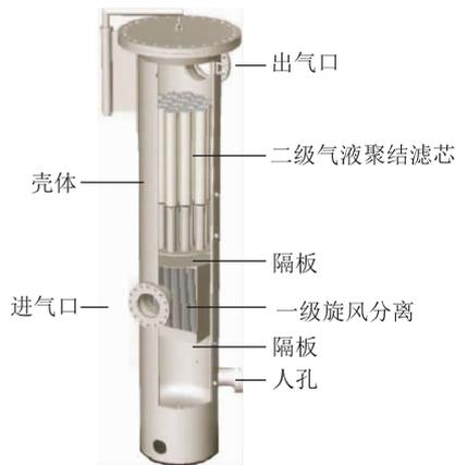
图8 组合式过滤分离器结构示意图
