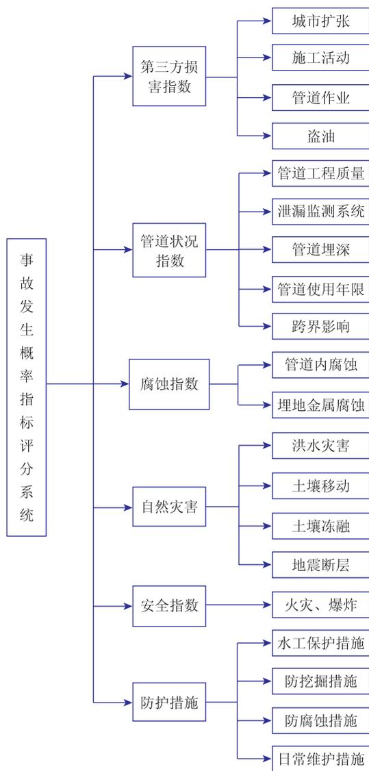
图1 长输管道事故概率评价系统指标体系
