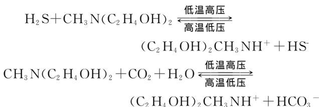
醇胺和  $H_2S$ 、 $CO_2$  的主要反应为可逆反应,在吸收塔中上述反应的平衡向右移动,原料气中的酸性气组分被脱除;在再生塔中则平衡向左移动,溶剂释放出酸性气组分。同所有其它吸收—再生反应过程一样,加压和低温利于吸收,减压和高温利于再生,但为了防止溶剂分解,再生温度通常低于  $127^\circ\text{C}$ <sup>[2]</sup>。典型的 MDEA 脱硫工艺流程如图 1 所示。
